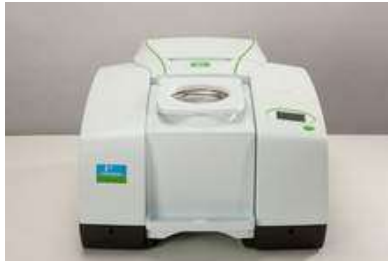
Perkin Elmer Spectrum 100N 10000-4000 \text{cm}^{-1}
